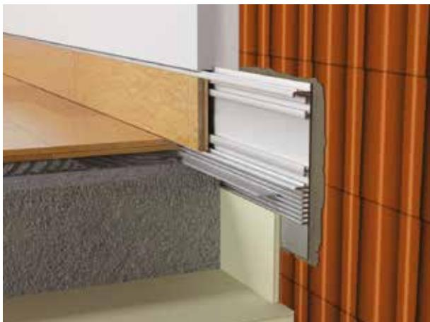
Plano BFZ est un profilé de construction qui permet de créer une plinthe au ras de la paroi avec le même matériau du sol. Les rainures dans la partie inférieure permettent d'installer un profilé linéaire à la hauteur souhaitée en fonction de l'épaisseur du sol au-dessus. Il sera donc le point de référence pour déterminer la hauteur des portes et des fenêtres.
